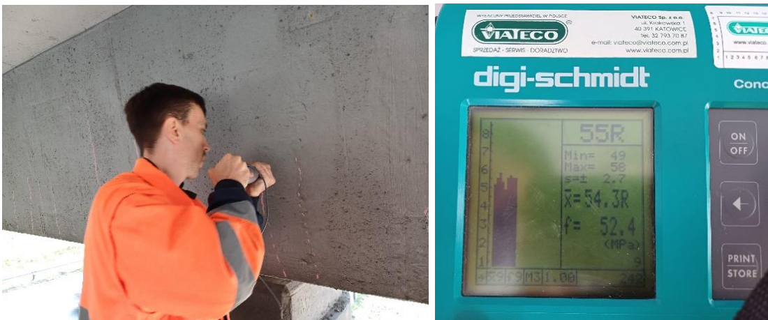
Rys. 3.3. Kontrolne badanie wytrzymałości betonu młotkiem Schmidta
